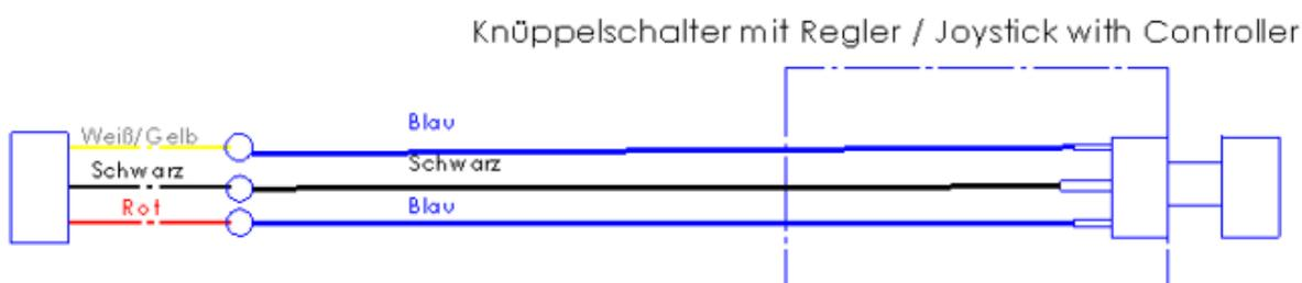
Den 2-adrigen Knüppeltaster anstelle des eingebauten 2-pos. Schalters SF links oder Tasters SH rechts verwenden.
