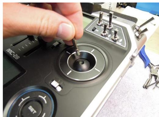
Knüppelschalter einfädeln, aufsetzen und anschrauben
