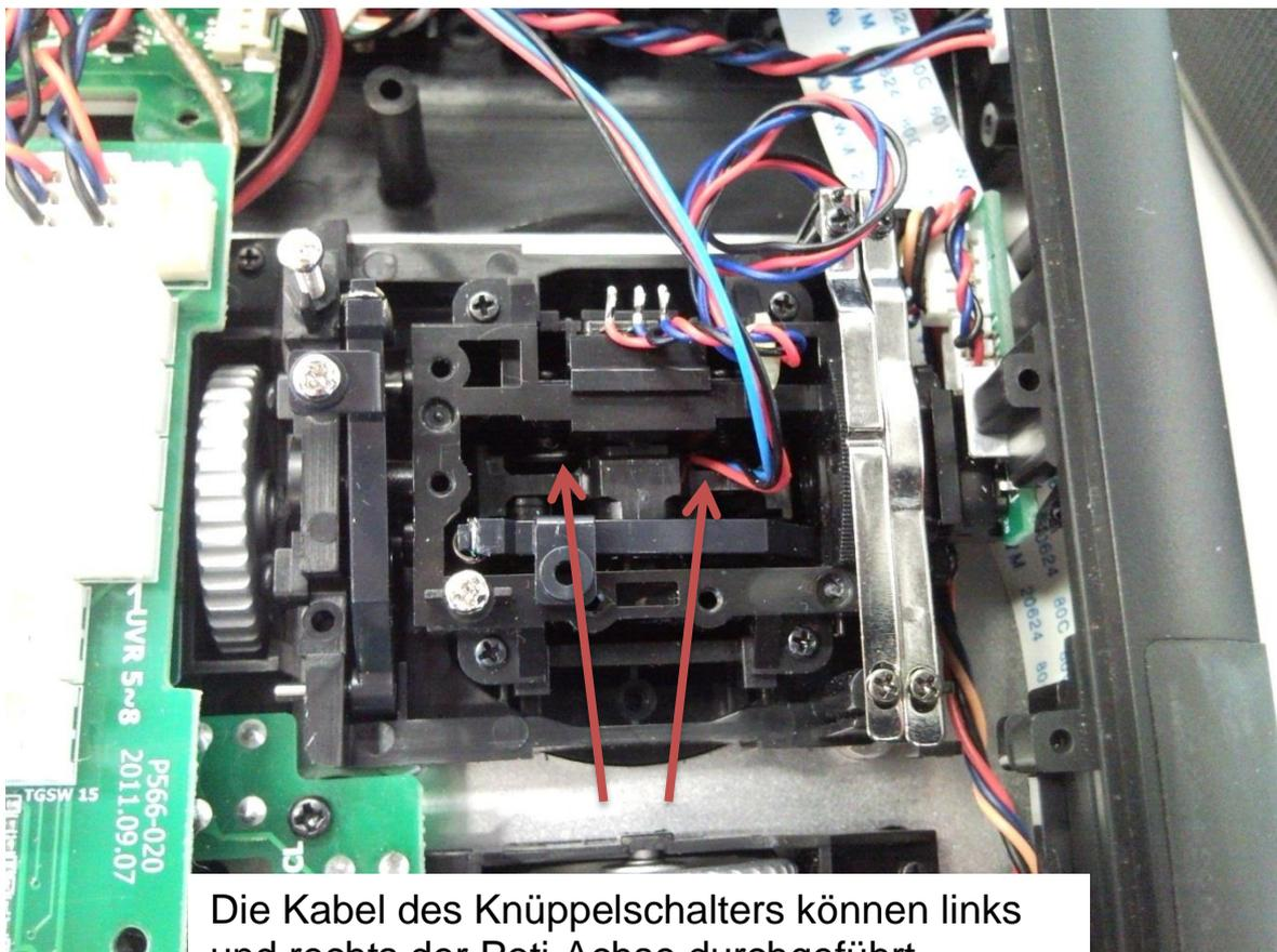
Die Kabel des Knüppelschalters können links und rechts der Poti-Achse durchgeführt werden.
