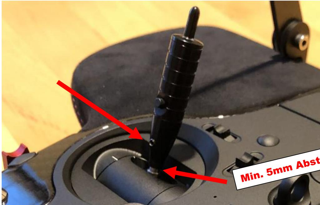
8. Kabel Knüppelschalter oben anschließen
