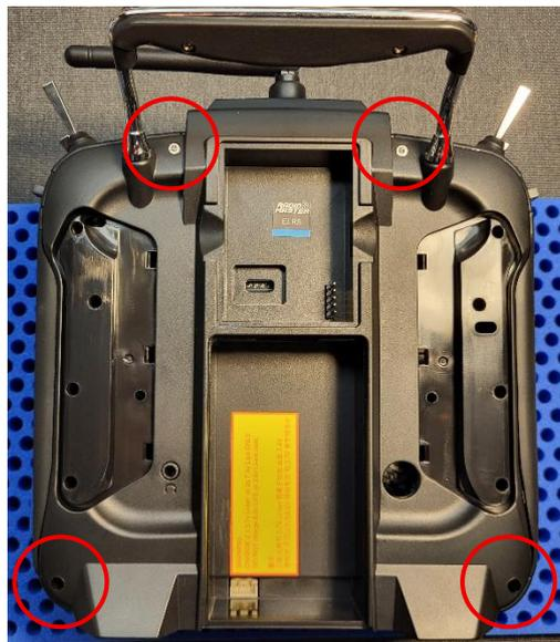
2 x Kunststoffseitenteile entfernen
