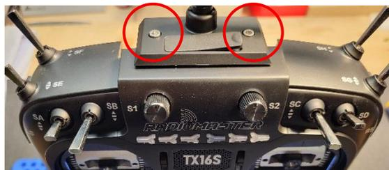
Kabel des Lautsprechers abstecken und Deckel entfernen
